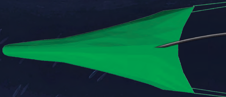
Cáp ngầm gắn vào dây lái Đối với tàu đánh cá dưới đáy có độ mở lưới thẳng đứng <12 mét
