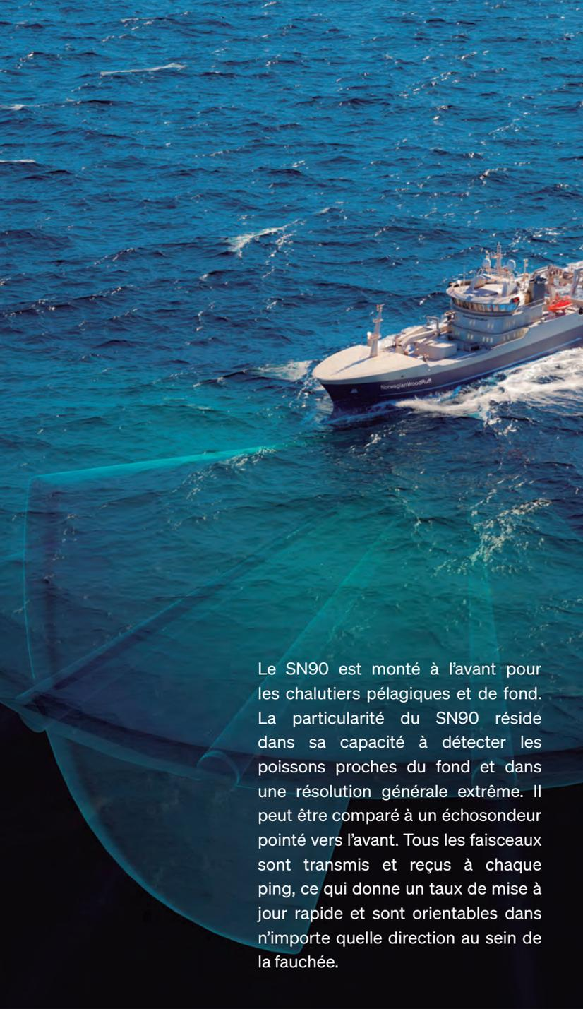
Le SN90 est monté à l'avant pour les chalutiers pélagiques et de fond. La particularité du SN90 réside dans sa capacité à détecter les poissons proches du fond et dans une résolution générale extrême. Il peut être comparé à un échosondeur pointé vers l'avant. Tous les faisceaux sont transmis et reçus à chaque ping, ce qui donne un taux de mise à jour rapide et sont orientables dans n'importe quelle direction au sein de la fauchée.
