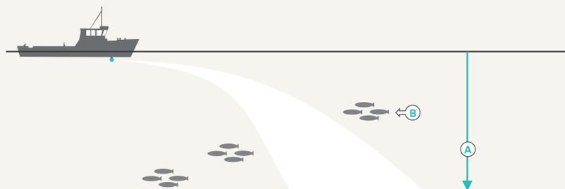
Avec l'augmentation de la température (A), le faisceau se courbera vers la surface, raccourcissant la portée (B).
