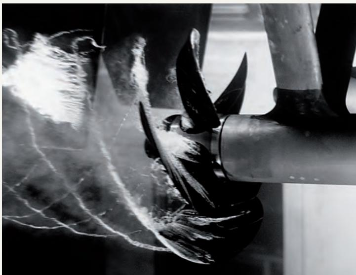
Le bruit de l'hélice est causé par la cavitation, comme illustré sur l'image de gauche. Une hélice propre va quand même caviter mais beaucoup moins qu'une hélice marquée et endommagée. De plus, une grande hélice cavitera beaucoup moins qu'une petite en raison du régime inférieur.
