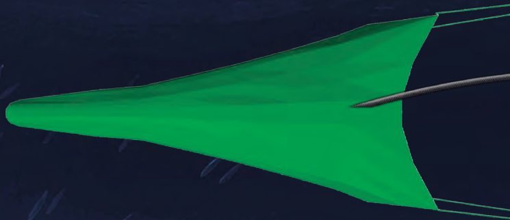
Cable submarino conectado a la relinga superior Para arrastreros de fondo con una abertura de red vertical de <12 metros
