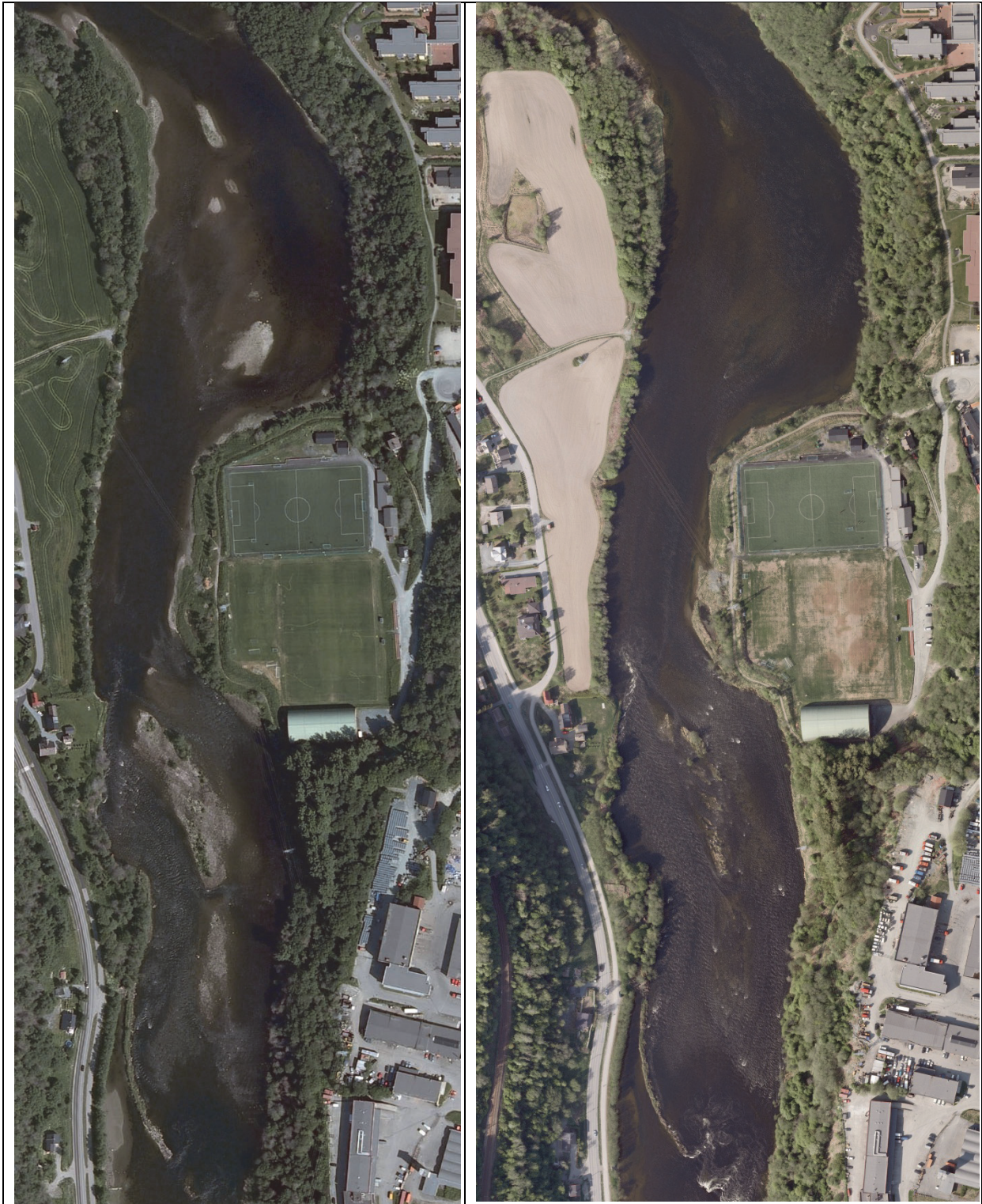
Bilde 1. Ortofoto av Nidelva ved Tempe på vannføring 38 m 3 /s (venstre) og 150 m 3 /s (høyre). Kilde © Norge digitalt.
