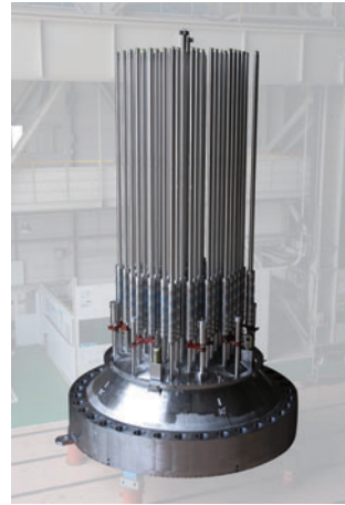
米国サウステキサス原子力発電所1・2号機向け取替用上部原子炉容器
