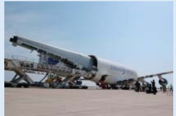
米国への空輸のため専用貨物機(ドリームリフター)へ積み込まれる787主翼初号機
