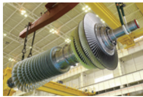
2011 世界最高効率のJ形ガスタービンが実証運転で世界最高のタービン入口温度1,600°Cを達成
