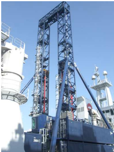
船上設置型ボーリングシステム
