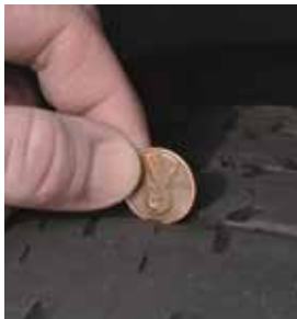
Banda de rodamiento de los neumáticos inadecuadas
