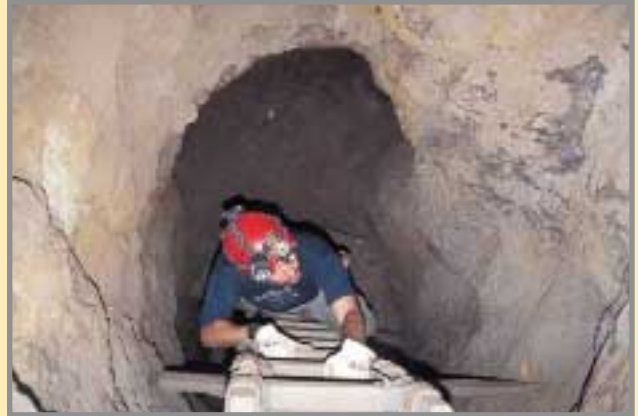
Descendiendo a los niveles inferiores de la explotación. Este contrapozo, bien conservado con sus escalas y descansos, da acceso a un sector de explotación con filones bien metalizados en bournonita. Foto: G. García.
