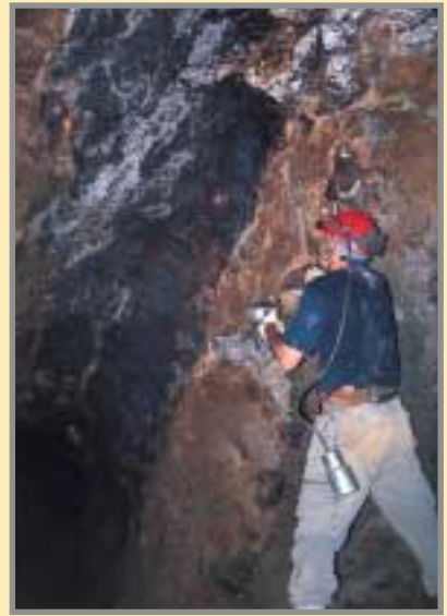
Frente de sideritización en el nivel 14 de la mina, afectando a capas sensiblemente verticales. Foto: G. García.
