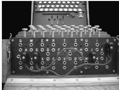
Abb. 36: Steckerbrett (im Bild ist A mit J und S mit O gesteckert)
