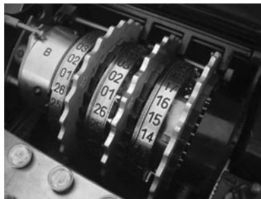
Abb. 34: Der Walzensatz aus drei rotierenden Walzen und der Umkehrwalze B (links)
