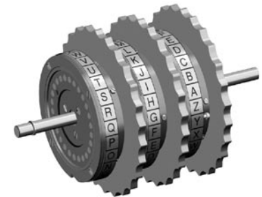
Abb. 37: Walzensatz: Links unten ist eine Übertragskerbe zu erkennen
