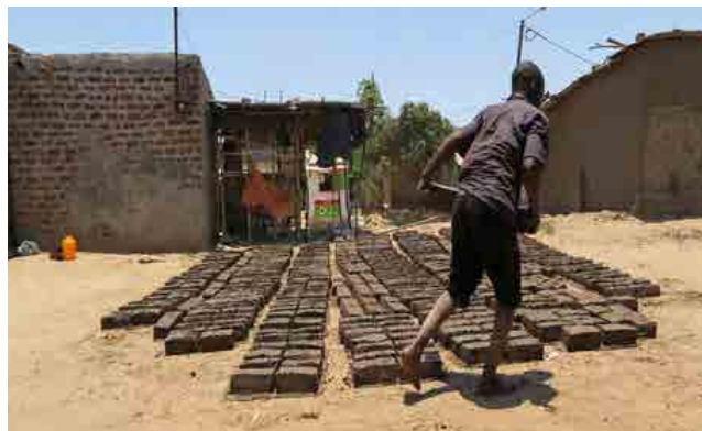
PRODUÇÃO INFORMAL DE BLOCOS, CHIMOIO. FONTE: JOOST MOHLMANN
