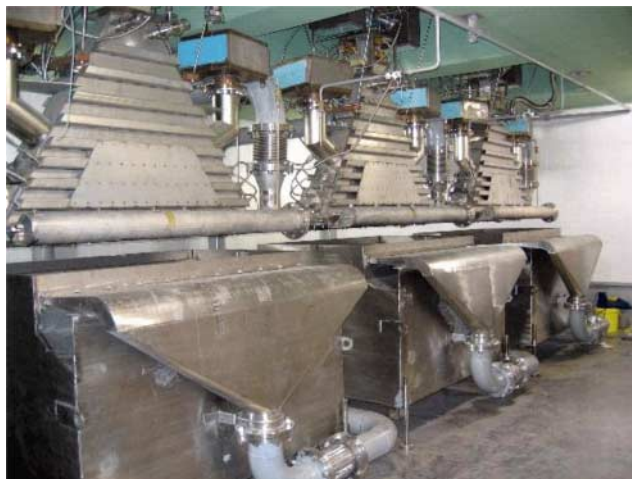
Рис. 4. Зал электронно-лучевой обработки сточных вод красильного производства (г. Тэгу, Южная Корея). На фотографии видны выпускные устройства ускорителя ЭЛВ-12 и реакторы для обработки воды.
