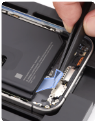
iPhone 电池使用先进的粘合剂进行固定, 这些粘合带在朝特定方向拉伸时会松脱, 因而可以更换电池。
