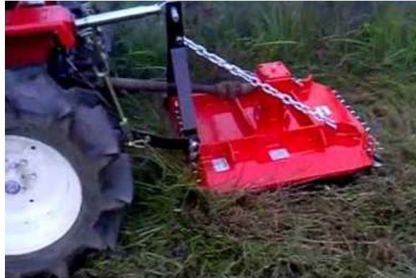
Figura 2.2. Corta-matos de acoplação a trator florestal.
