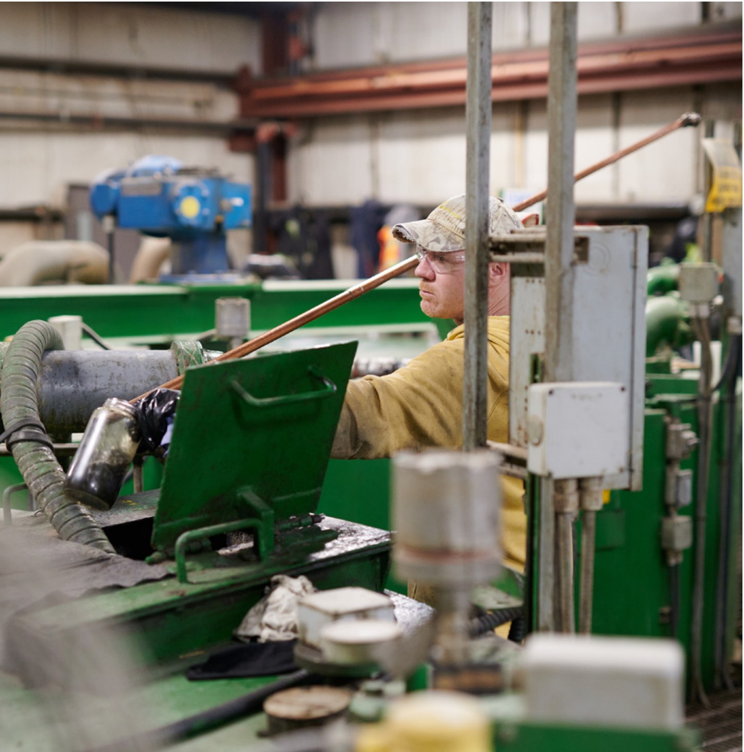
Jeff Mead prélève un échantillon d'une cuve de traitement dans une installation de traitement des eaux usées industrielles d'Aevitas Inc.
