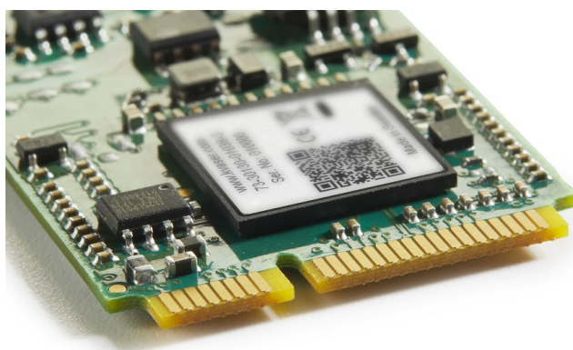
Figure 2: Mini PCI Express connector
