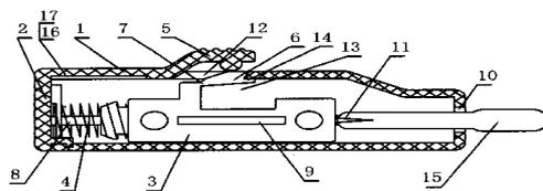
1、一种自毁型一次性安全自动采血针，包括：壳体、针芯[3]以及弹簧[4]，壳体构成一个弹射腔，弹射腔的前端设有出针孔[10]，针芯[3]滑动设在弹射腔内，针芯[3]的前部设有针尖[11]，该针尖[11]正对出针孔[10]，弹簧[4]设在针芯[3]后部的弹射方向上，针芯[3]与壳体侧向在弹簧压缩路径上设有卡射结构，其特征在于：该卡射结构由壳体上的弹臂按钮[5]和针芯[3]上的弹性臂[6]构成，弹臂按钮[5]为壳体侧向的一个延伸结构，其按钮作用端面对壳体侧壁上所设的锁定孔[12]，弹性臂[6]为针芯[3]侧向的一个延伸结构，其末端在锁定状态下与锁定孔[12]配合，其根部设有容易产生应力集中的切口[7]或收缩颈。
