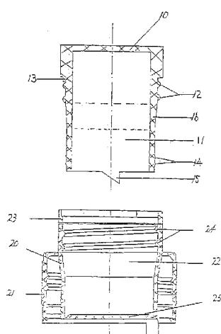
1、一种管状旋开式溶质与溶剂分隔瓶盖，主要是由上盖和由下盖体和下盖内置管组成的下盖组成，其特征在于：下盖内置管的上端设有一保险环，上盖的外侧设有外螺纹。
