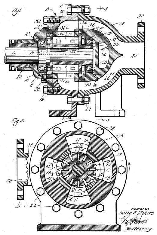
VANE PUMP OR MOTOR
