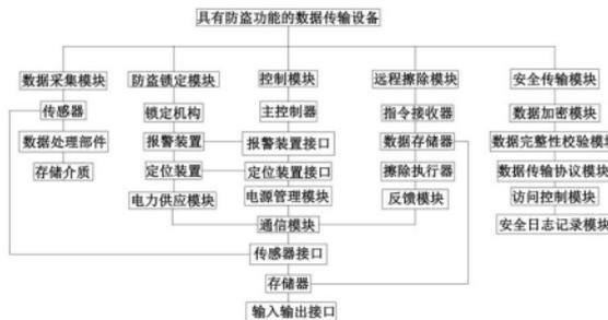
1. 一种具有防盗功能的数据传输设备,其特征在于,包括数据采集模块、防盗锁定模块、远程擦除模块、安全传输模块和控制模块;
