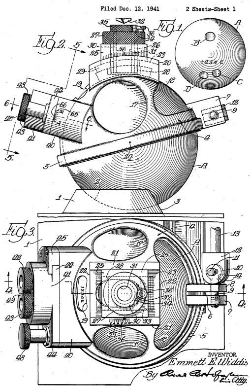
BOWLING BALL DRILLING FIXTURE
