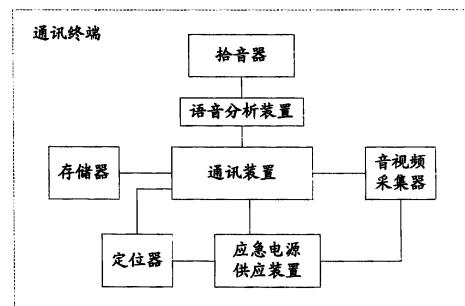
1. 一种具有报警功能的通讯终端，包括拾音器、存储器、通讯装置，其中，所述存储器中存储有预存号码，所述通讯装置被触发后根据指定的预存号码自动与报警平台进行通讯，其特征在于，还包括一个语音分析装置，分别与所述拾音器、通讯装置相连，根据拾音器获取的语音信号分析出符合预设音频信息时，触发所述通讯装置。
