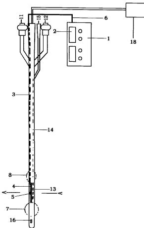
1. 一种前列腺疾病及女性尿道综合症治疗装置，其特征在于：该治疗装置是由提供治疗光源的主机（1）、控温仪（2）、药物灌注装置、尿道内治疗导管（3）和设置在导管（3）上的光源发射极（4）组成；尿道内治疗导管（3）为两囊导尿管结构，光源发射极（4）安装在导管（3）的两气囊定位气囊（7）和封闭气囊（8）之间，提供治疗光源的主机（1）通过传输线（6）与光源发射极（4）连接；控温仪（2）与设置在光源发射极（4）上的温度敏感器（5）连接并控制光源发射极（4）的温度为 $41\pm1^{\circ}\text{C}$ 。
