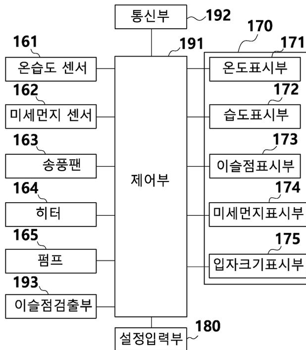
하여 입력하는 설정 입력부(180)와, 상기 설정 입력부(180)로부터 설정 입력된 출력 범위를 기초로 상기 온습도 센서(161)로부터 입력된 온습도값을 상기 표시부(170)로 출력하는 제어부(191)와, 상기 제어부(191)의 제어를 기초로 온습도 센서(161)가 측정된 온습도를 원격으로 전송하는 통신부(192)를 포함하여 구성되는 산업용 계측기에 있어서, 공기 중의 미세먼지의 농도( $\mu\text{g}/\text{m}^3$ )를 측정하여 상기 제어부(191)로 출력하는 미세먼지 센서(162)와, 상기 표시부(170)에 구비되고, 상기 미세먼지 센서(162)가 측정된 미세먼지의 농도를 제어부(191)의 제어를 기초로 표시하는 미세먼지 표시부(175)가 더 포함되어서 구성되는 것을 특징으로 하고, 이에 의하면 계측기 자체에서 미세먼지를 측정할 수 있는 이점이 있다.
