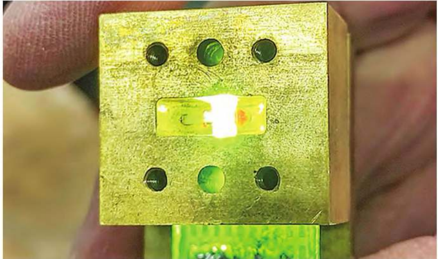
אור ירוק שואב את פגמי ה-Nitrogen vacancy בגביש יהלום הנצא במהוד מתכתי ומאפשר את פעולת מגבר המיקרוגל הקוונטי ברעש נמוך. קרדיט צילום: דוברות הטכניון
