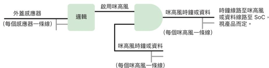
在具有硬件咪高風截斷功能的每項產品中，一或多個外蓋感應器會使用互動的某些物理屬性 (例如，霍爾效應感應器或鉸鏈角度感應器) 來偵測外蓋或護殼的實際閉合程度。對於需要校正的感應器，在裝置生產期間會設定參數，並且校正過程包括不可逆轉的硬件鎖定，以防止對感應器上敏感參數進行任何後續變更。這些感應器發出直接的硬件訊號，該訊號通過一組簡單、不可重新編寫程式的硬件邏輯。這些邏輯提供去抖動、滯後作用和/或最多 500ms 的延遲，然後再停用咪高風。視產品的不同，可以藉由停用在咪高風和單晶片系統 (SoC) 之間傳輸資料的線路或藉由停用咪高風模組中使其處於作用狀態的其中一條輸入線路，例如時鐘線路或類似的有效控制，來執行此訊號。
