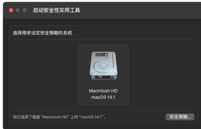
在搭载 Apple 芯片的 Mac 上, “系统安全性实用工具”会指明用户配置的 macOS 整体安全性状态, 如 Kext 的启动或系统完整性保护 (SIP) 配置。如果更改安全性设置会显著降低安全性或使系统更易遭到入侵, 则用户必须通过按住电源按钮进入 recoveryOS (使恶意软件无法触发信号, 只有用户通过实际接触才能触发) 才能进行更改。因此基于 Apple 芯片的 Mac 也不要求提供 (亦不支持) 固件密码, 所有关键更改已经由用户授权保护。有关 SIP 的更多信息, 请参阅[系统完整性保护](#)。
