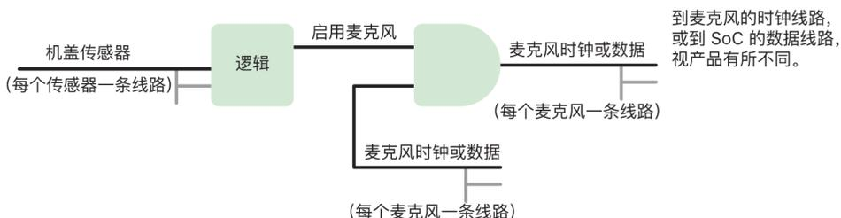
每款支持硬件切断麦克风的产品都有一个或多个机盖传感器, 可通过用户交互的某些物理属性 (如霍尔效应传感器或铰链角度传感器) 检测到机盖或保护壳以物理方式盖上的行为。对于需要校准的传感器, 其参数会在设备的生产过程中设定, 校准过程还会包括不可逆的硬件锁定, 以阻止对传感器上敏感参数的任何后续更改。这些传感器会发出直接的硬件信号, 该信号会通过一组简单的不可重新编程的硬件逻辑。此逻辑会在停用麦克风前提供防抖、滞后和/或最高 500 毫秒的延迟。根据产品的不同, 此信号可通过停用麦克风和片上系统 (SoC) 之间用于传输数据的线路来实现, 或停用连接到麦克风模块上允许其启用的其中一个输入线路来实现, 如时钟线路或类似的有效控制。
