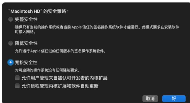
“宽松安全性”与基于 Intel 且搭载 T2 芯片的 Mac 上“无安全性”还有一点不同：“宽松安全性”是某些过去可独立控制的安全性降级的先决条件。最明显的表现是，若要在搭载 Apple 芯片的 Mac 上停用系统完整性保护 (SIP)，用户必须确认要为系统启用“宽松安全性”。需要用户确认是因为停用 SIP 始终会将系统置于内核更易遭到入侵的状态。尤其是在搭载 Apple 芯片的 Mac 上停用 SIP 会在 AuxKC 生成期间停用 Kext 签名实施，从而允许将任意 Kext 载入内核内存。在搭载 Apple 芯片的 Mac 上，针对 SIP 的另一改进是将策略储存移出 NVRAM 并移入 LocalPolicy。因此，现在需要具有 LocalPolicy 签名密钥访问权限的用户进入 recoveryOS (通过按住电源按钮)，在其中进行认证后才能停用 SIP。此功能使仅软件层面的攻击者 (甚至处于电脑前的攻击者) 停用 SIP 的难度显著提高。
