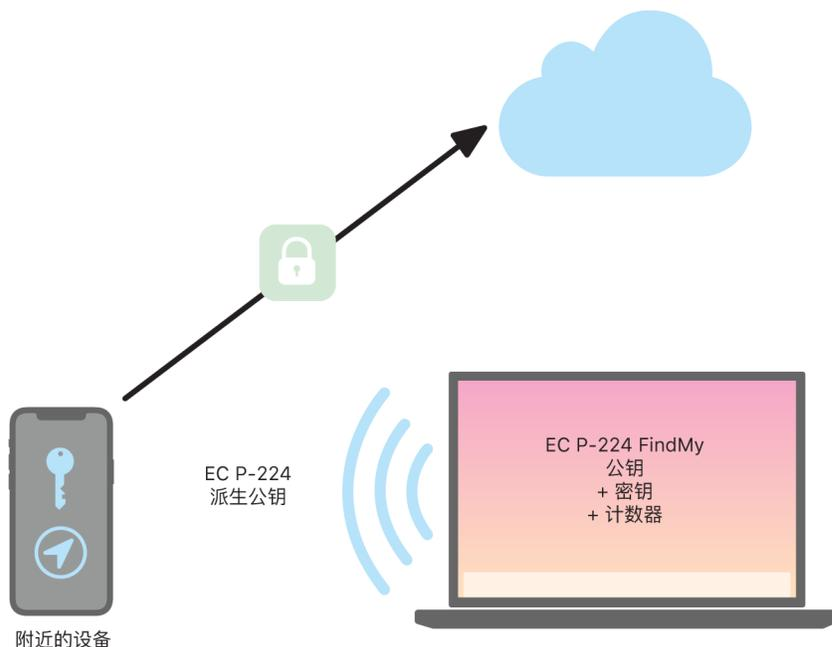
尝试定位丢失的设备时，会为位置搜索期间预估一个计数器值的预期范围。设备所有者知道搜索期间计数器值范围中的原始 P-224 私钥  $d$  和密钥值  $SK_i$  后，便可重构整个搜索期间的值集  $\{d_i, \text{SHA256}(P_i)\}$ 。然后，用于定位丢失设备的设备所有者可使用索引值集  $\text{SHA256}(P_i)$  来查询服务器并从服务器下载已加密的位置。“查找”App 随后使用匹配的私钥  $d_i$  在本地解密已加密的位置，并在 App 中显示丢失设备的大致位置。多台查找设备报告的位置会由所有者的 App 整合以生成更精确的位置。
