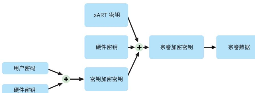
在搭载 Apple 芯片的 Mac 和搭载 T2 芯片的 Mac 上, 所有文件保险箱密钥的处理都发生在安全隔区中; 加密密钥绝不会直接透露给 Intel CPU。所有 APFS 宗卷默认使用宗卷加密密钥创建。宗卷和元数据内容使用此宗卷加密密钥加密, 该密钥使用密钥加密密钥 (KEK) 封装。文件保险箱启用时, KEK 受用户密码和硬件 UID 共同保护。
