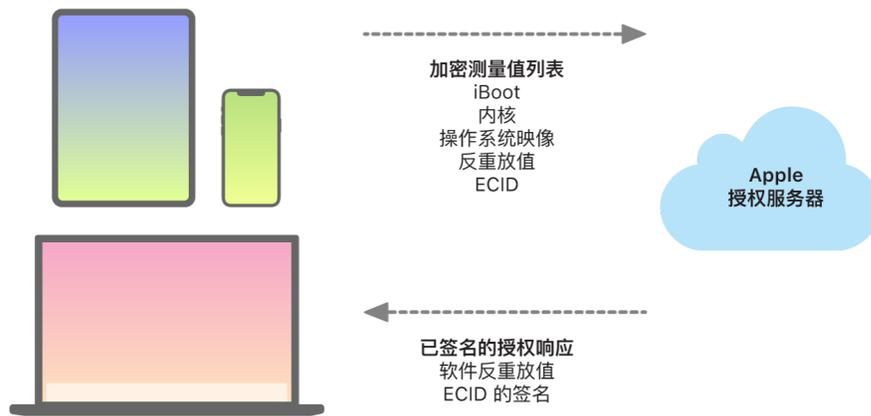
启动时信任链评估会验证签名是否来自 Apple, 并结合设备的 ECID 验证从储存设备载入的项目测量值是否与该签名认可的内容相匹配。这些步骤旨在确保在支持定制化的设备上授权只针对特定设备, 且较旧的操作系统或固件版本无法从一台设备拷贝到另一台。反重放值可帮助防止攻击者存储服务器的响应和利用该响应来破坏设备或通过其他方式篡改系统软件。
