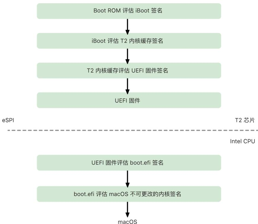
通过验证后, UEFI 固件映像会映射到 T2 芯片内存的某个部分。此内存通过增强的串行外设接口 (eSPI) 供 Intel CPU 访问。Intel CPU 首次启动时, 它会通过 eSPI 从 T2 芯片上进行了完整性检查和内存映射的固件副本中获取 UEFI 固件。
