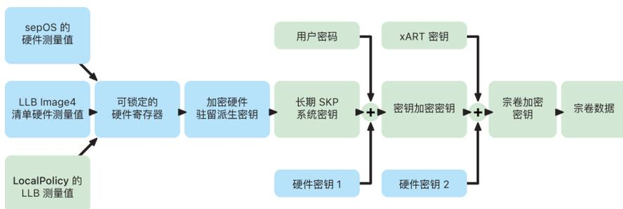
安全隔区启动监视器会捕获所加载的安全隔区操作系统的测量值。当应用程序处理器 Boot ROM 测量附于 LLB 的 Image4 清单时, 该清单也包含所有其他已加载的系统配对固件的测量值。LocalPolicy 包含已加载 macOS 的核心安全性配置。还包含 **nsih** 字段, 它是 macOS Image4 清单的哈希值。macOS Image4 清单包含所有与 macOS 配对的固件和 macOS 核心启动对象 (如启动内核集或签名系统宗卷 (SSV) 根哈希值) 的测量值。
