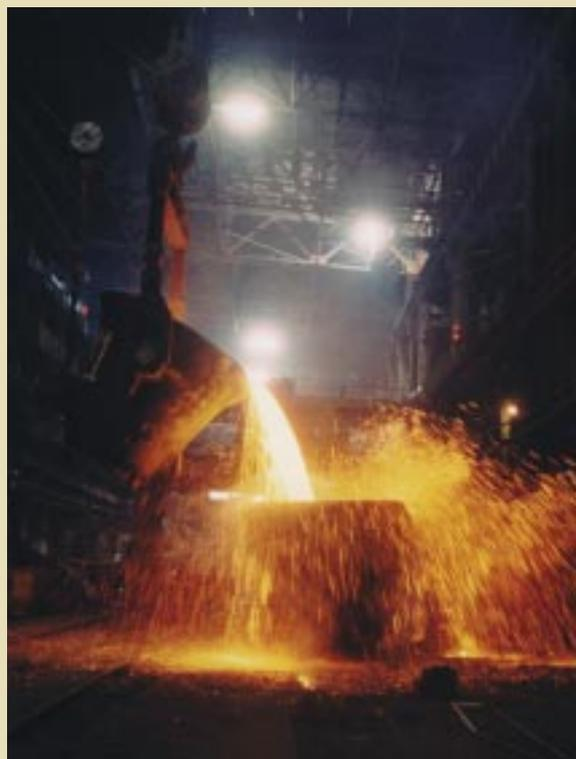
溶解した銅・ニッケル・マットの流し込み(ノリルスク・ニッケルのNadezhda製錬所)
