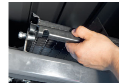
Extracción de las cribas
