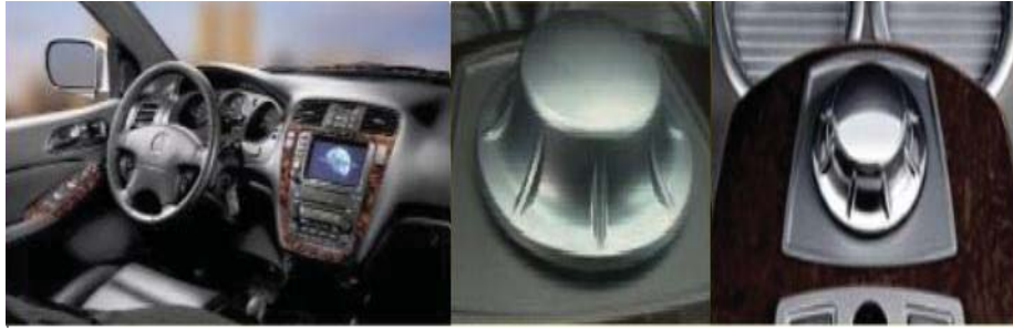
Şekil-2: Arabalarda Haptik Düğme Uygulaması
