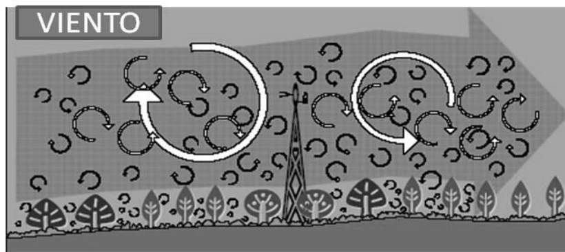
Figura 1: Esquema del comportamiento turbulento del viento en las capas bajas de la atmósfera.
