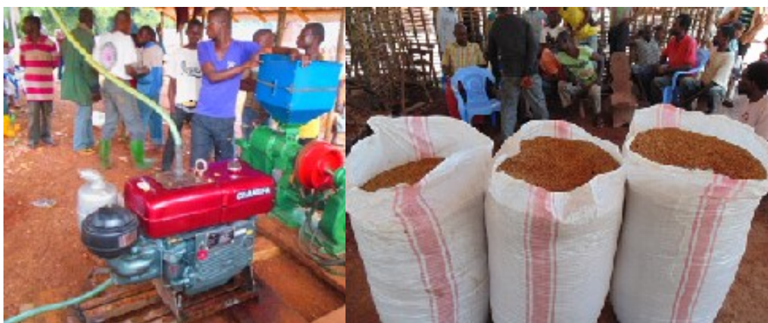
A gauche, la décortiqueuse de paddy à Batama et à droite les sacs de paddy prêts au décorticage / (Photo BOTOKO KENDEWA)
