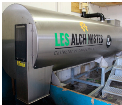
FIGURE 2. PHOTO DU COMPOSTEUR ÉLECTROMÉCANIQUE, SITE DES GRANDS VOISINS
