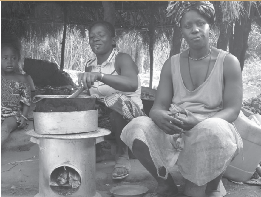
Photo 3 GUINÉE: Le cuiseur à bois économe type «rocket stove» est un foyer de cuisson performant, composé d'une chambre de combustion coudeée, d'une enveloppe assurant l'isolation extérieur, d'une grille pour poser le bois facilitant la circulation de l'air. Pour mesurer l'efficacité des cuiseurs, trois protocoles de tests différents sont utilisés et reconnus par APROVECHO, (Centre américain pour le développement et la diffusion de cuiseurs écologiques). Ces tests mesurent la consommation de bois, le temps mis pour atteindre l'ébullition, le calcul du rendement et de la puissance, attestant ainsi d'une réduction de la consommation de bois de plus de 50%.
