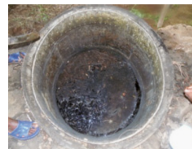
(C) Cuve ou cucurbitte d'alambic
