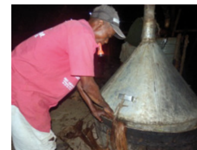
(D) Etanchéité de la cuve avec le chapiteau
