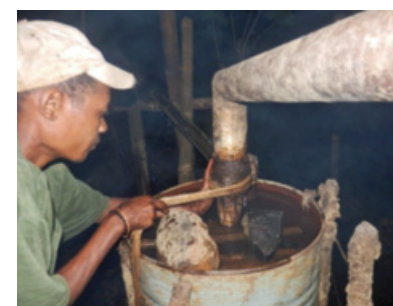
(E) Jonction entre le col de cygne et le condenseur
