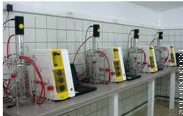
Photos 19 : Batterie de biofermenteurs
