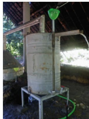
(G) Réfrigérant à contre courant
