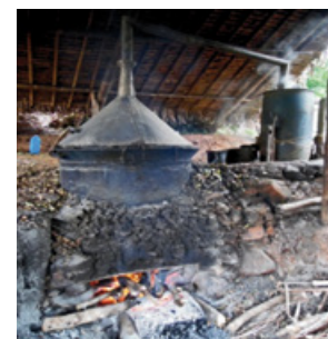
(A) Alambic traditionnel d'extraction
