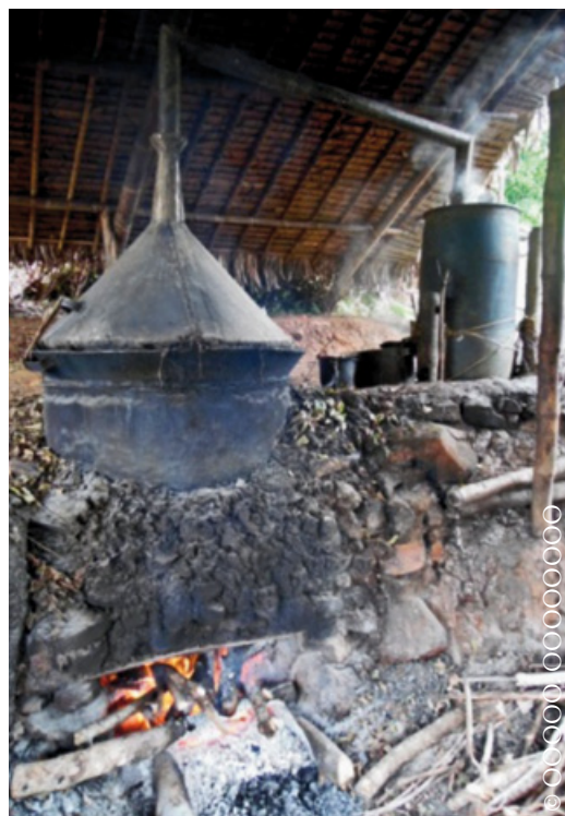
Photo 2 : Alambic de distillation
