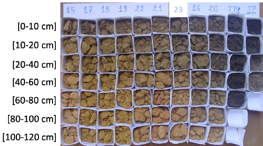
Figure 20 : Sondages tarière effectués à MIL Madeira (15 à 23) et dans une terra preta (TP37 et TP35). Les caractéristiques de ces sondages (couleur, texture, ...) sont données dans l'Annexe 6. A l'exception du sondage 19, les sondages sont ordonnés suivant la texture, des sols argileux (gauche) aux sols sableux (droite).
