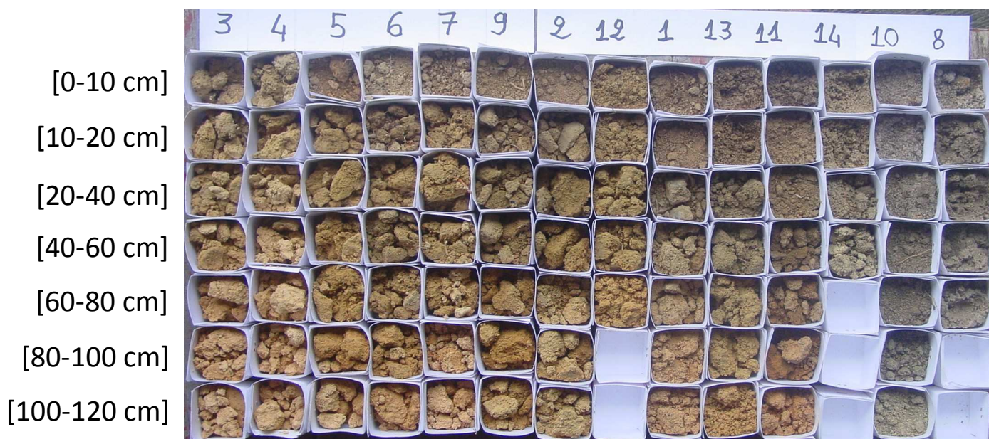
Figure 7 : Sondages tarière effectués dans le dispositif DAS. Les caractéristiques de ces sondages (couleur, texture, ...) sont données dans l'Annexe 4. Les sondages sont classés en fonction de la texture, des sols argileux (gauche) aux sols sableux (droite).
