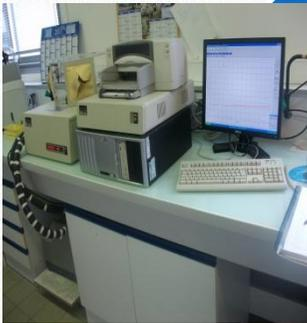
la DSC pour mesurer les transitions affectant l'amidon (sur une DSC 7 de marque Perkin-Elmer, en utilisant des capsules en acier inoxydable)
