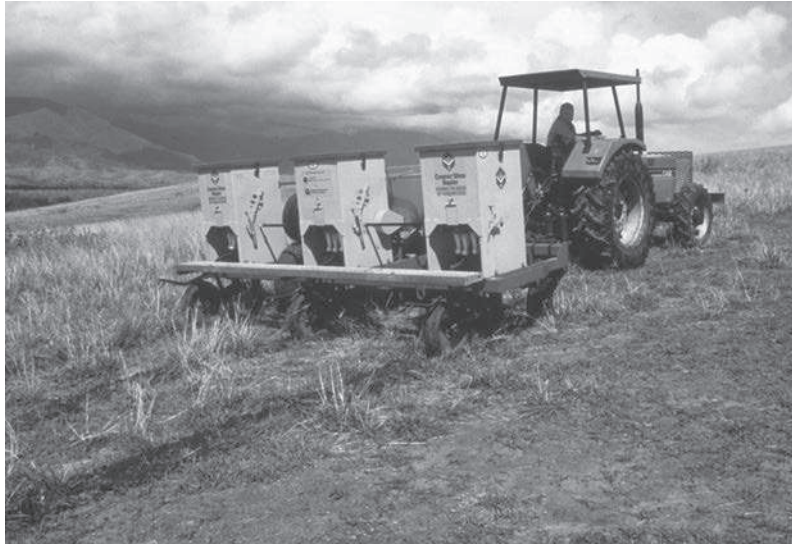
Photo 5.3. Sursemoir australien à trois bandes ( band seeder ) pour améliorer un pâturage dégradé, Nouvelle-Calédonie. (© H. D. Klein)
