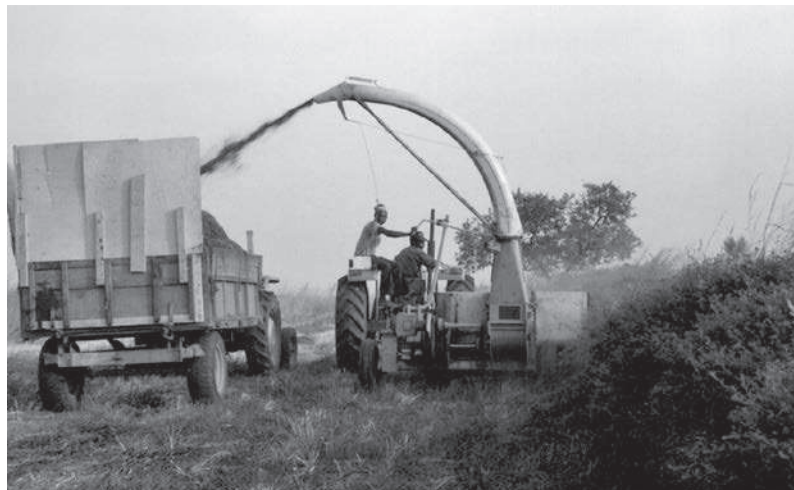
Photo 6.4. Faucheuse-ensileuse en action, parcelle de Stylosanthes guianensis sur la station fourragère de Wakwa, N'Gaoundéré, Adamaoua, Cameroun. (© G. Rippstein)
