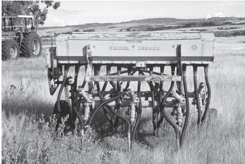
Photo 5.5. Sursemoir australien ( Chisel seeder ), côte ouest de Nouvelle-Calédonie. (© H. D. Klein)
