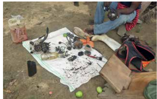
Photo 4 : Le démontage d’une tronçonneuse pour réparation (photo de P.Tshimpanga)
