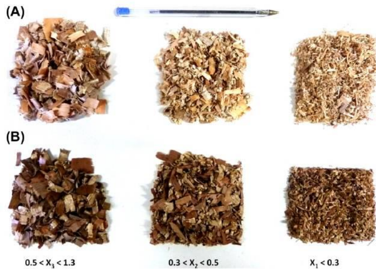
Figure 24 : Répartition granulométrique du mélange : (A) avant torréfaction – (B) après torréfaction à 200°C /15min
