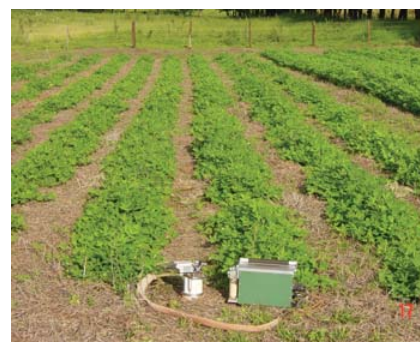
Figura 5. Amendoim no sistema plantio direto sobre pastagem e destaque para equipamento LI-6400 para leitura do fluxo de \text{CO}_2 . Apta Centro-Norte, Pindorama, março de 2004
