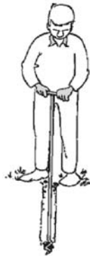
Figure 4 : sondage à la tarière
