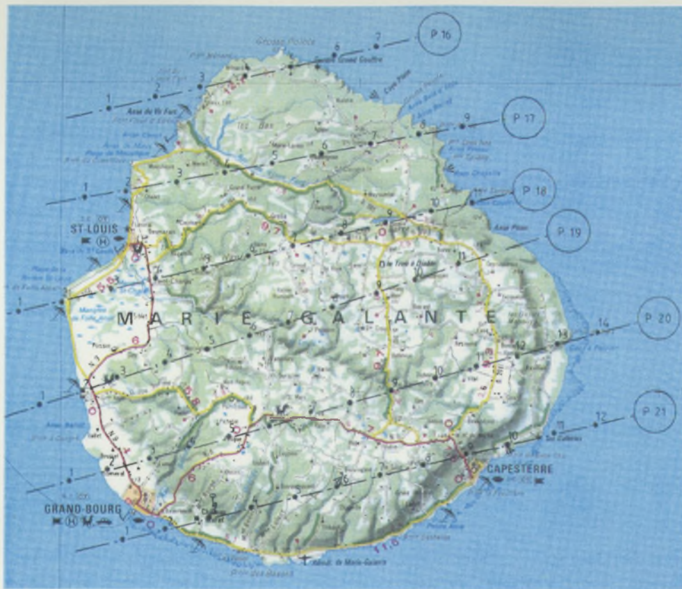
Figure n° 29 : Tableau d'assemblage des bandes de vol P16 à P21 sur Marie-Galante reportées sur fond topographique IGN au 1/100 000 e
