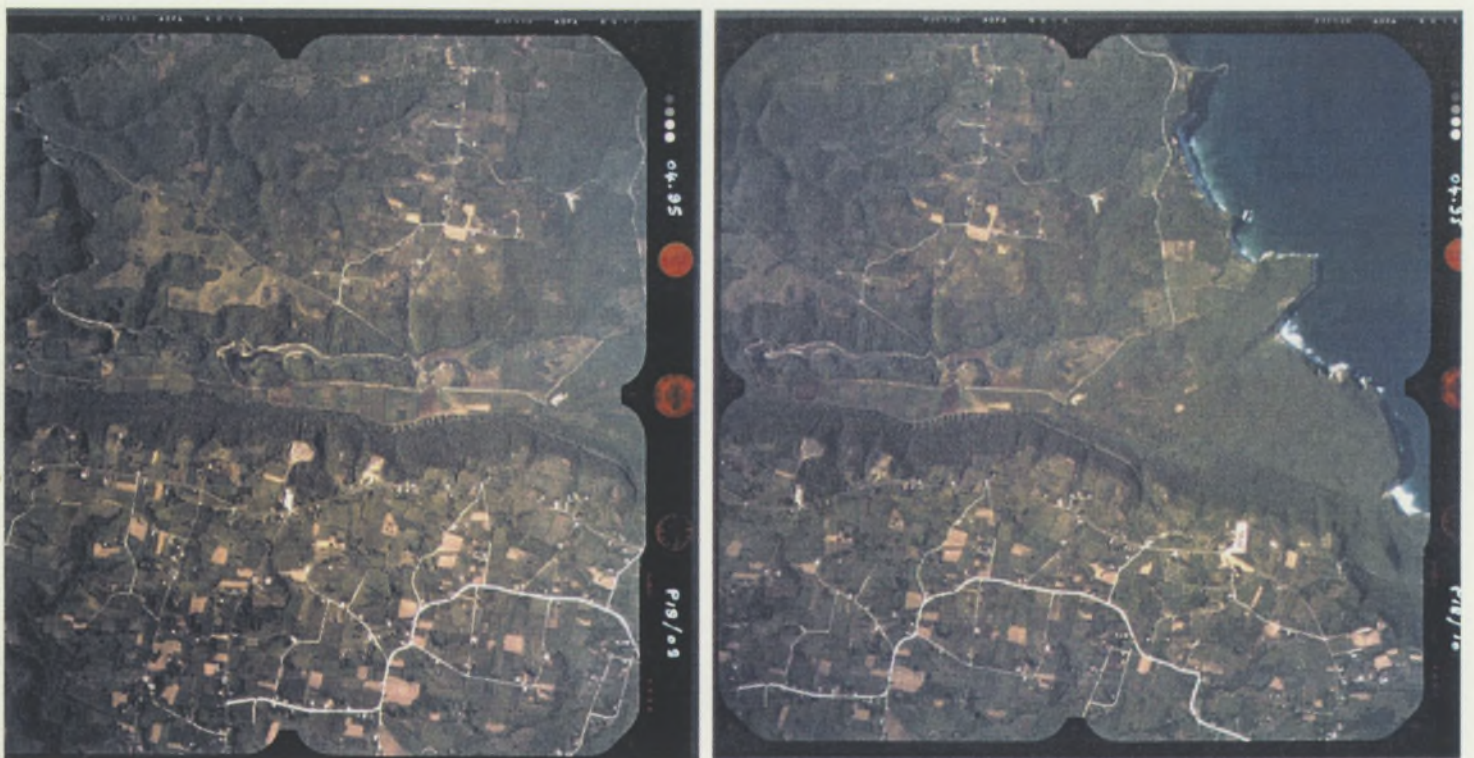
Figure 30 : Exemple de couple stéréoscopique (recouvrement longitudinal de 60%) (clichés 9 et 10 passe 18)
