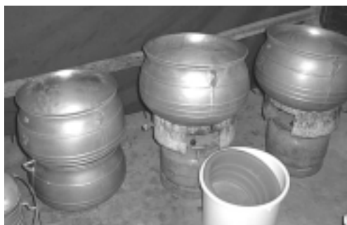
Marmites pour le chauffage du lait cru
