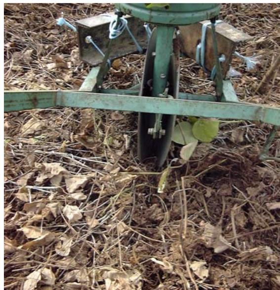
Semoir mono-rang à disques trancheurs
