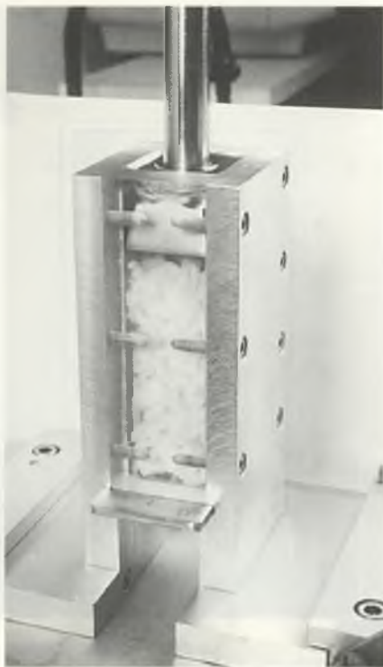
Mesure de la fermeté du riz cuit à l'aide du texturomètre INSTRON.
