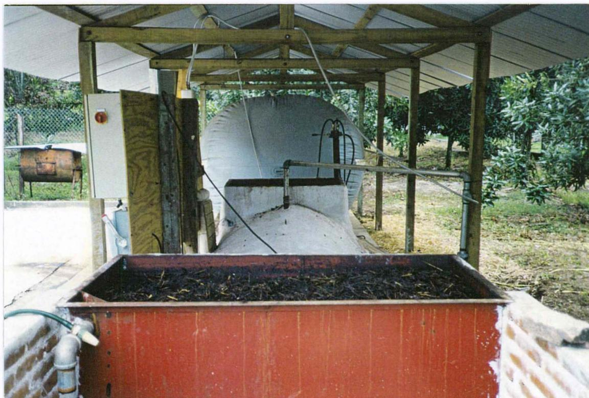
Effluent constitué de paille et de pulpe fermentée en fin de phase de démarrage
