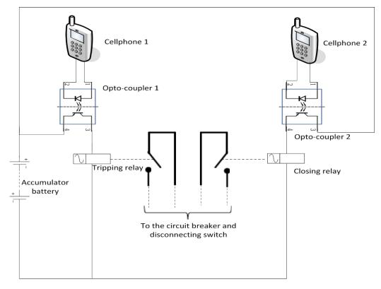
Figure 4. Wireless Remote for sous-station de la SNCC
