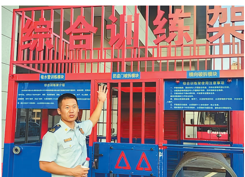
张方军和队友研发的“综合训练架”,集成吸水管训练、防盗门破拆、卷帘门破拆等12种训练模式,大大提升了消防员的训练效率 本报记者 陈欣 摄
